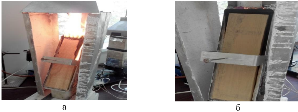
Рис. 1. Вигляд зразків під час випробувань: а – незахищеної деревини; б – захищеної покриттям.
