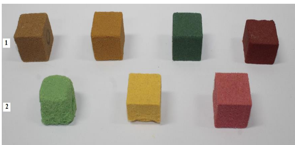
Рис. 1. Фото зразків доломітової цегли після 25 циклів випробувань на морозостійкість: 1 – зразки на основі залізоокисних пігментів; 2 – зразки на основі ДФП.
