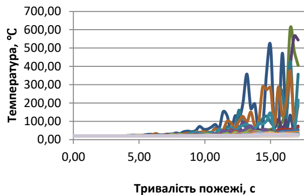
Рис. 2. Фрагмент дослідження температурних розподілів в середовищі пожежі трав'яного настилу висотою 0,2 м з використанням моделі WFDS.
