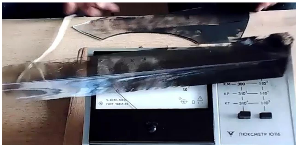
Рис. 1. Фрагмент дослідження методу оцінки кількості кіптяви на поверхнях оптичним методом.
