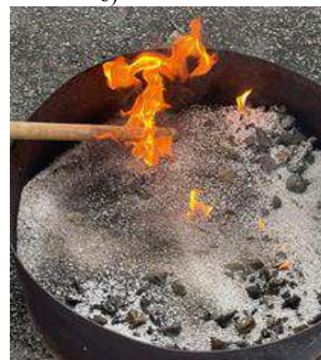
Рис. 1. Етапи гасіння модельного вогнища пожежі «8В»: а) зменшення висоти полум'я під час подавання ПС; б) зменшення висоти полум'я під час подавання ПС; в) припинення горіння після подавання води; г) дослід на повторне займання.
