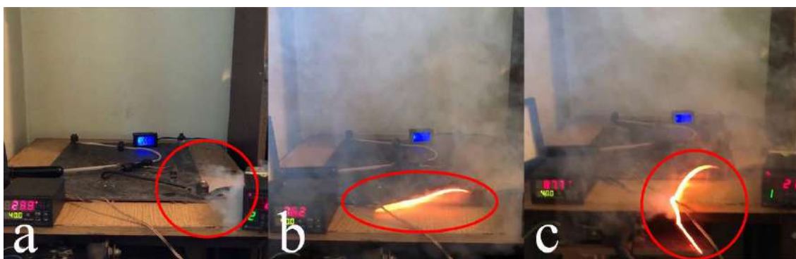
Рис. 1. Момент втрати цілісності внаслідок короткого замикання провідника для з'єднання фотоелектричних систем.
